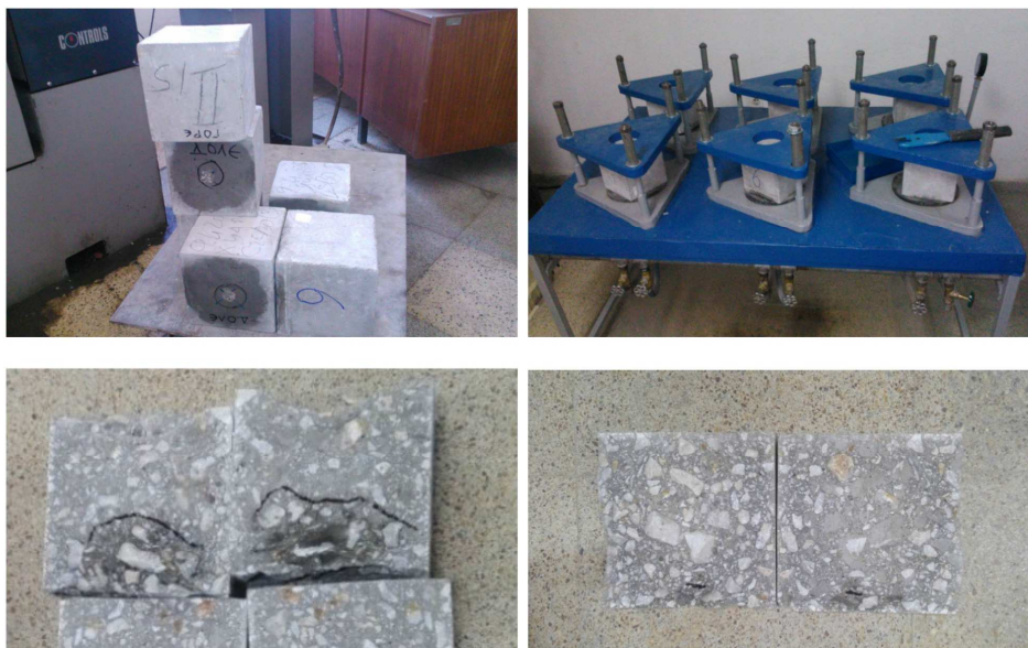
Slika1: Ispitivanje otpornosti betona na prodor vode pod pritiskom
