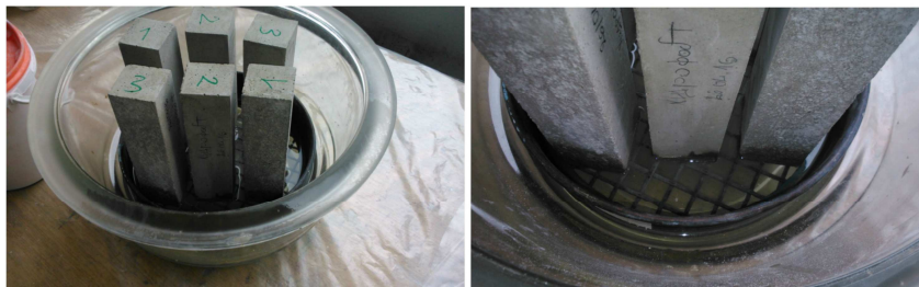
Slika 4: Ispitivanje otpornosti betona na kapilarnu apsorpciju
